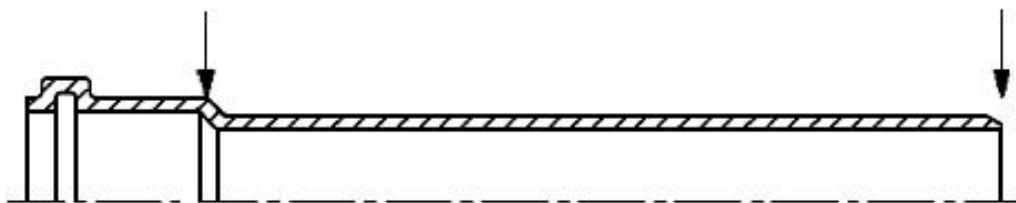
а) Труба с раструбом под уплотнительное кольцо
